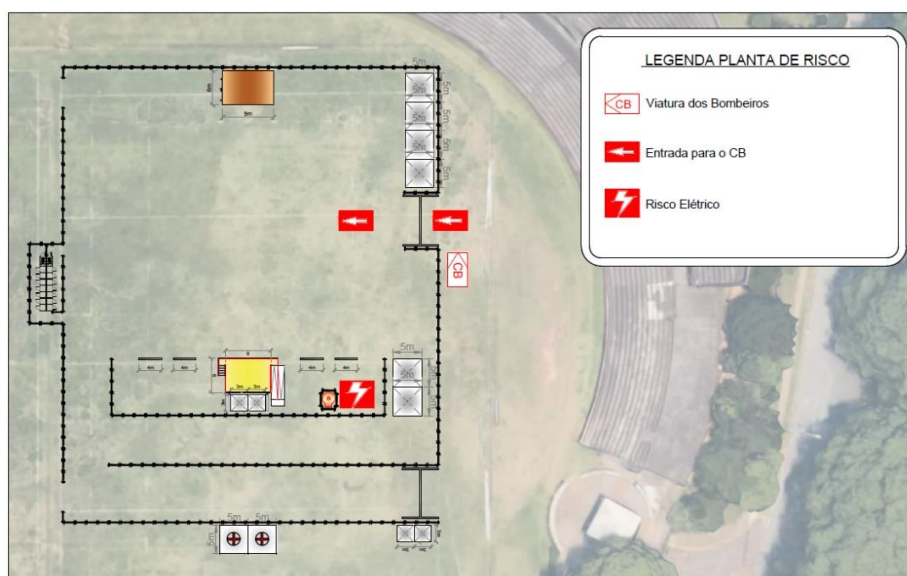
Figura 45 -Planta de Risco de incêndio
